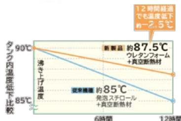
※メーカー調べ。タンク湯温を90°Cに沸き上げ運転後、7°C環境下に12時間放置したあとのタンク湯温をメーカー従来製品BHP-FV37ND (2013年発売) と比較。
